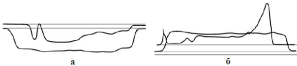
Рис. 2. Осциллограммы сил со стороны полосы на боковые линейки со стороны входа (а) и выхода (б)
