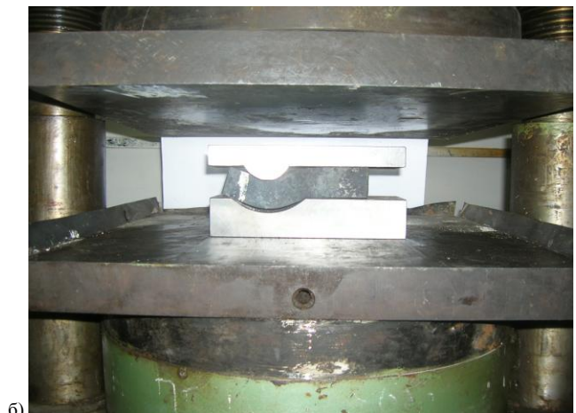
Рис. 3. Деформирование заготовок в выпукло-вогнутых бойках: а – в бойках с шириной выступа равной ширине впадины ( m=n ); б – в бойках с шириной выступа меньше ширины впадины ( m < n )
