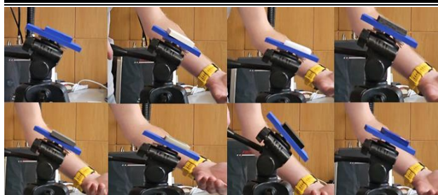
Фиг. 4 Снимки от експеримента за намиране коефициент на триене при плъзгане
