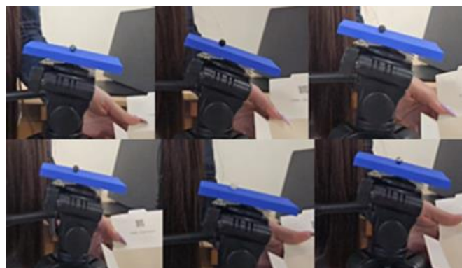
Фиг. 2 Снимки от експеримента по намиране на коефициент на триене при търкаляне
