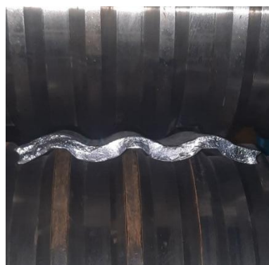
Рис. 1. Прокатка в рельефных валках с геометрической асимметрией
