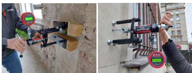
Фиг. 6 Изпитване за определяне на носимоспособността на опън на анкер, монтиран от вътрешната и външната страна на фасадните стени
