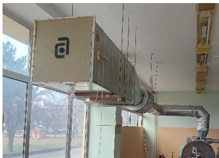
Фиг. 5 Монтиран опитен образец (мрежа 1-M1) в изходната част на ветровия тунел (канал) – TV град София
